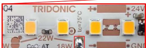
Bei Strips die länger als 3 Meter sind, muss alle 3 Meter eine Zinnbrücke für die Leistungseinstellung gesetzt werden!
